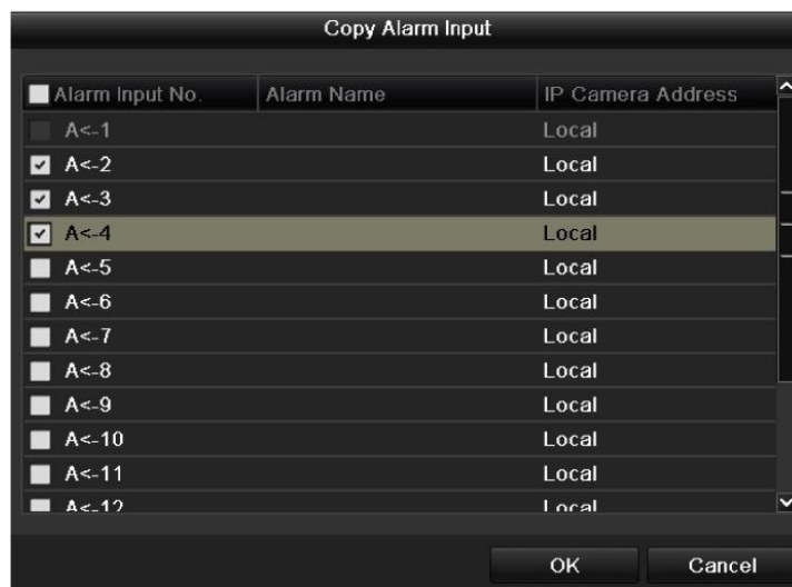
Obr. 8.10 Kopírování nastavení poplachového vstupu
